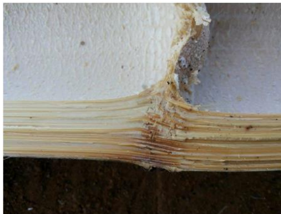
Figura 2 – Disposição das fibras de bambu de forma paralela.
